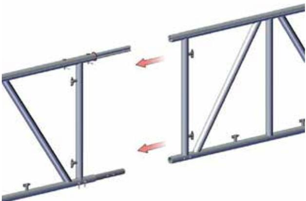
Wenn die beiden Einschubrohre gesichert sind, wird der zweite Notdachträger oder Firstträger eingeführt.
