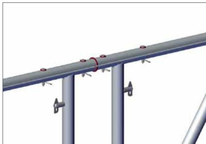
Nun wird auch der zweite Notdachträger oder Firstträger mittels Bolzen, Federvorstecker und Moosgummidichtungen mit dem Einschubrohr verbunden und somit gesichert.
