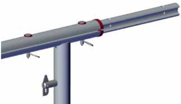
Die Bolzen werden anschliessend mit dem Federvorstecker gesichert. Ebenfalls wird das Einschubrohr beim Untergurt durch Bolzen und Federvorstecker gesichert.
